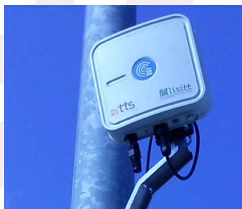
Imagen 2: Dispositivo sensor con encapsulado IP68 para exteriores
